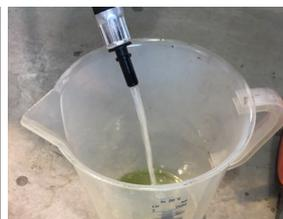
19. Kontrollieren Sie, ob der DPF-Tank leer ist. Sollte es Flüssigkeitsreste geben, schließen Sie ein offenes Verbindungsstück an den DPF-Schlauch an und platzieren Sie dieses in einen Behälter. Drücken Sie 3 Sek. lang im DPF-Programm auf den Startknopf, um den Tank zu entleeren.
