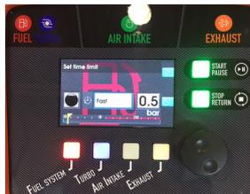
12. Drücken Sie 3 Sekunden lang im Kraftstoffprogramm auf den Startknopf, um die Maschine zu ent-leeren. Wenn diese leer ist, legen Sie die Verbindungsstücke wieder ins Set und hängen die Schläuche in die Halterung.
