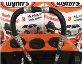
6. Formen Sie eine Schlaufe zwischen der Kraftstoffzufuhr- & -rückfuhr mit den Schläuchen des Adaptersets.
