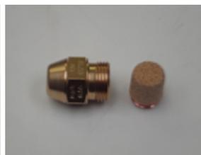
18. Wenn die Verneblung nicht gut ist, entfernen Sie den Atomiser (16mm Schlüssel), reinigen Sie ihn mit Bremsenentfetter, trocknen Sie ihn, platzieren Sie ihn mit Bremsenentfetter, trocknen Sie ihn, platzieren Sie ihn erneut. Info: Verwenden Sie eine kleine Menge Schraubensicherungslack auf den Schrauben, und ziehen Sie diese an.
