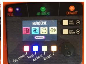
10. Wählen Sie "Fuel System" und starten Sie die Maschine. Kontrollieren Sie, ob die Flüssigkeit zurück in den Tank läuft.
