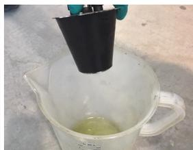
17. Wenn die Verneblung gut ist, platzieren Sie den Atomiser in einen Behälter. Drücken Sie auf "Return" und starten Sie das Intake-Programm nochmals. Drücken Sie 3 Sekunden lang auf den Startknopf, um den Tank zu entleeren.
