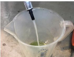
11. Stoppen Sie die Maschine und entfernen Sie die Schlaufe mit einem offenen Verbindungsstück der Zufuhr (roter Schlauch) und platzieren Sie dieses in einen Behälter.
